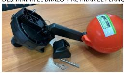
RETIRAR EL **RESORTE METAL Y PIEZA PLASTICA** (SUGERIMOS GUARDAR PARA UN POSIBLE CAMBIO EN PARTE SUPERIOR )
